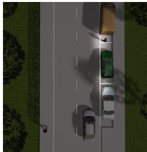
Aree in cui il veicolo intelligente pone l'attenzione per identificare eventuali pedoni in attraversamento
