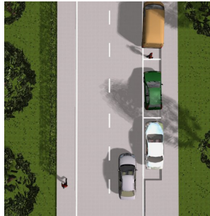
Pedone in attraversamento occluso da veicoli parcheggiati
