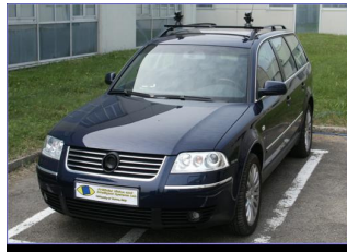
Volkswagen Passat e Touareg localizzazione pedoni con telecamere all'infrarosso
